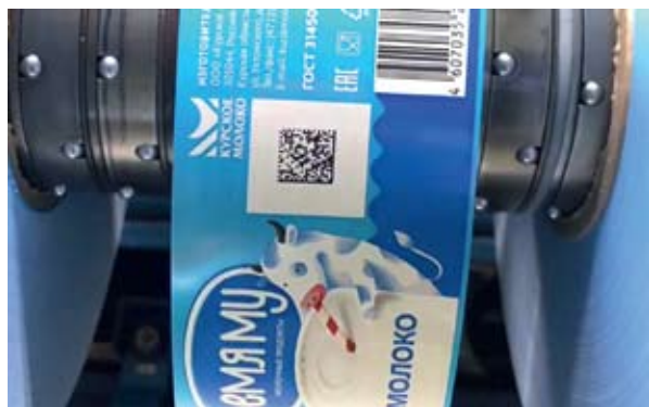
Рис. 1. Слева — в типографии: верификация (проверка считываемости) кодов на бобинорезальной машине, в центре кадра хорошо виден DataMatrix-код системы «Честный знак». Справа — у производителя молочной продукции: валидация (ввод товара в оборот) при сканировании нанесенных на бутылки молока кодов
