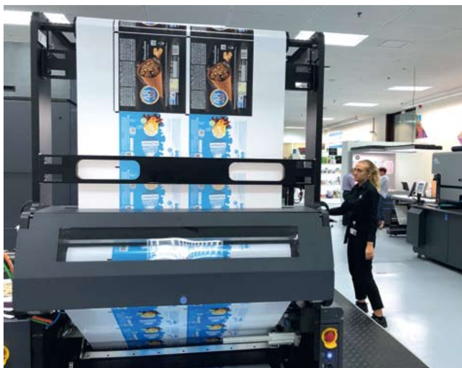
Рис. 4. Тестовая печать упаковки мороженого с DataMatrix-кодами на HP Indigo
