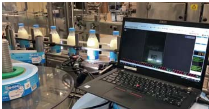
Рис. 1. Слева — в типографии: верификация (проверка считываемости) кодов на бобинорезальной машине, в центре кадра хорошо виден DataMatrix-код системы «Честный знак». Справа — у производителя молочной продукции: валидация (ввод товара в оборот) при сканировании нанесенных на бутылки молока кодов
