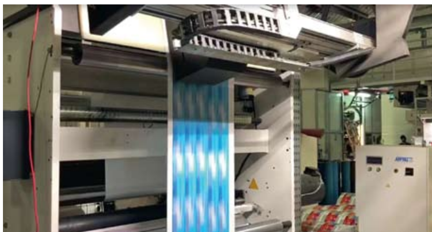
Рис. 3. Впечатывание кодов на флексомашине в российской типографии
